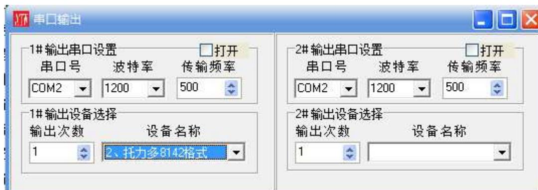
可选择从电脑自带的串口向大屏幕输出数据,选择好串口号,及大屏幕型号,可将当前软件中的数据向大屏幕输出
